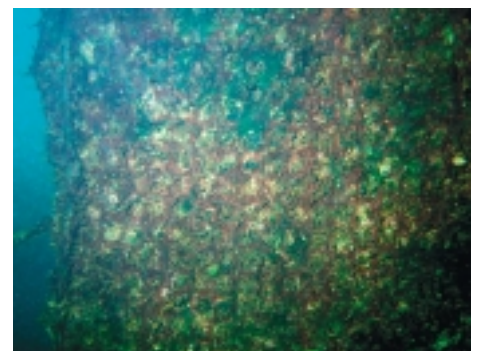
Abb. 5 und 6: Auf dem Gitterrost der Plattform (Foto 5 vom Februar 2008) und am senkrecht hängenden Netz (Foto 6 vom November 2008) sind kompakte Ablagerungen zu sehen, auf denen sich Grün- und Blaualgen sowie Bakterien angesiedelt haben. Das ergaben mikroskopische Untersuchungen der Biogruppe 2008.
