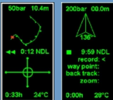
Auf dem TAMIN-Display wird die zurückgelegte Route angezeigt. Auf dieser Strecke führt das System den Taucher zum Ausgangspunkt zurück. Es kann aber auch Alternativen empfehlen, wenn der von einem speziellen Sensor gemeldete Pressluftdruck für den „Heimweg“ nicht ausreichen würde.
